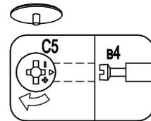
ориентация стяжки C5 – показана на рис. после сборки с дюбелем B4 стяжку затянуть по стрелке
